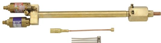
Il cannello macchina BS/86 è stato realizzato per la sfiammatura automatica di lastre o superfici piane; il cannello dispone di un sistema interno per il raffreddamento ad acqua della testa e della pietra tramite tridente.
